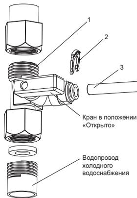
Рисунок 2. Узел подключения
