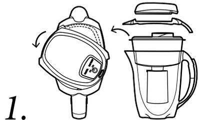
Снимите с водоочистителя крышку и выньте воронку.
