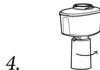
Распакуйте и установите новый модуль в отверстие воронки так, чтобы выступы модуля попали в пазы на воронке, поверните его до упора.
