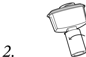
Поверните старый модуль против часовой стрелки и выньте из отверстия воронки.
