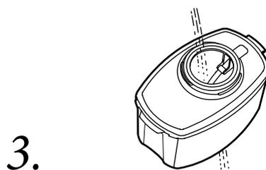
Промойте водой корпус, воронку и уплотнение блока электроники.
