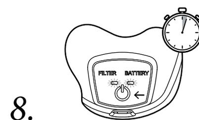
Для обнуления отсчета ресурса удерживайте кнопку включения
