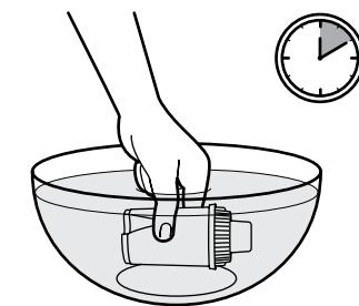
Распакуйте новый модуль и погрузите в холодную воду на 10 мин.
