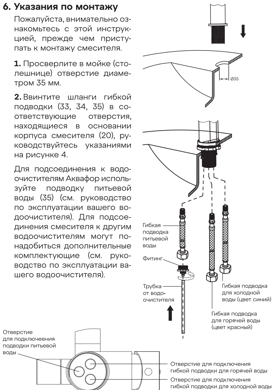
Рисунок 4. Расположение отверстий для подсоединения подводки
